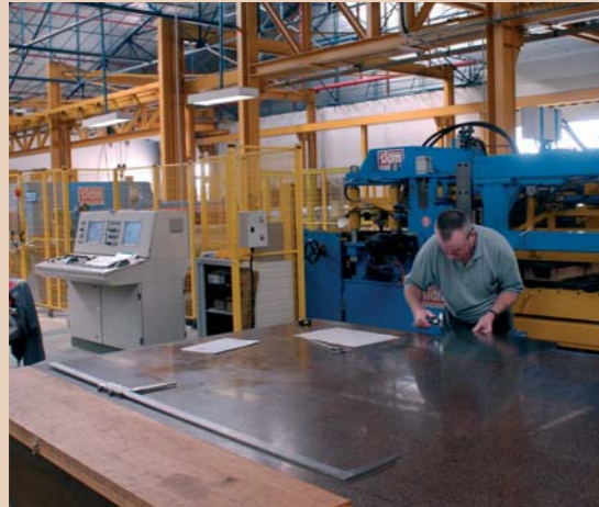
Contrôle de la planéité des tôles sur marbre Marble is used to ensure steel panels are 100% level
